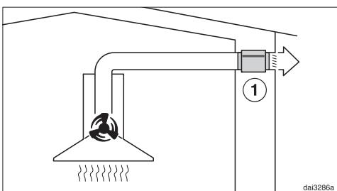
Prigušivač zvuka prigušuje šumove ventilatora prema van, ali i vanjske šumove koji kroz odvodnu cijev prodiru u kuhinju (npr. ulična buka). Zato se prigušivač zvuka pozicionira što je moguće bliže izlazu odlaznog zraka ①.
