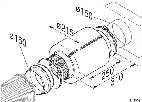
U odvodnu cijev može se umetnuti prigušivač zvuka (dodatni pribor) koji služi za dodatno prigušivanje šumova.
